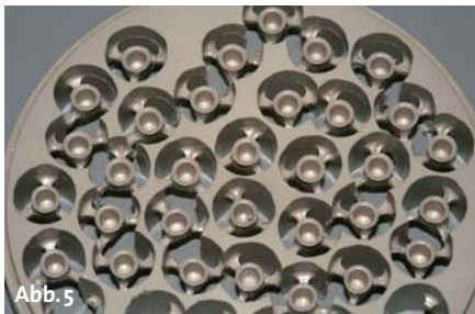
Abb. 5: Aus sogenannten Blanks gefräste PEEK-Prothetikteile (Dentalscheiben Tizian PEEK Blank der Firma Schütz Dental GmbH). – Abb. 6: Keine radiologische Sichtbarkeit des PEEK-Käppchens. – Abb. 7: Konuskronen-Sekundärteile aus PEEK vor dem Abtrennen aus dem Blank.
